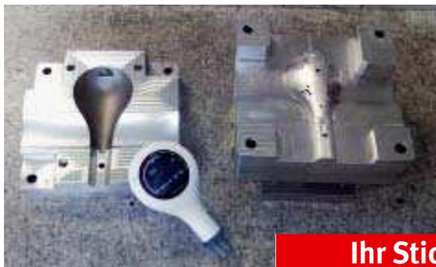
Die für Sensor hergestellten Aluminiumformen für das Spirometer werden für den Spritzguss in Stammformen eingesetzt
