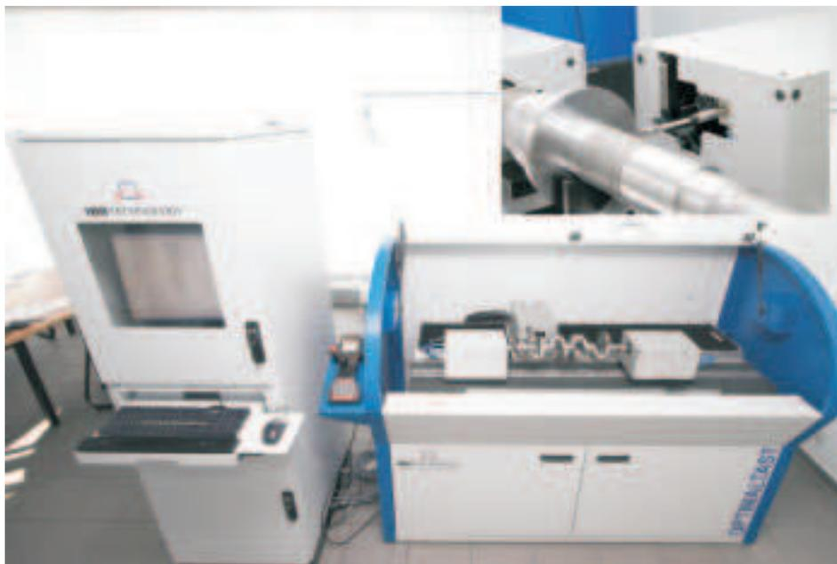
**Präzise, flexibel, formschön, ergonomisch und kompakt: Die Optimalast 220-3+ ermöglicht das  $\mu$ -genaue Vermessen von bis zu 80 kg schweren Teilen mit maximal 220 mm Durchmesser und 800 mm Länge. Maschinen für größere Werkstücke seien laut IBB möglich. (Bilder: Klaus Hennecke)**
